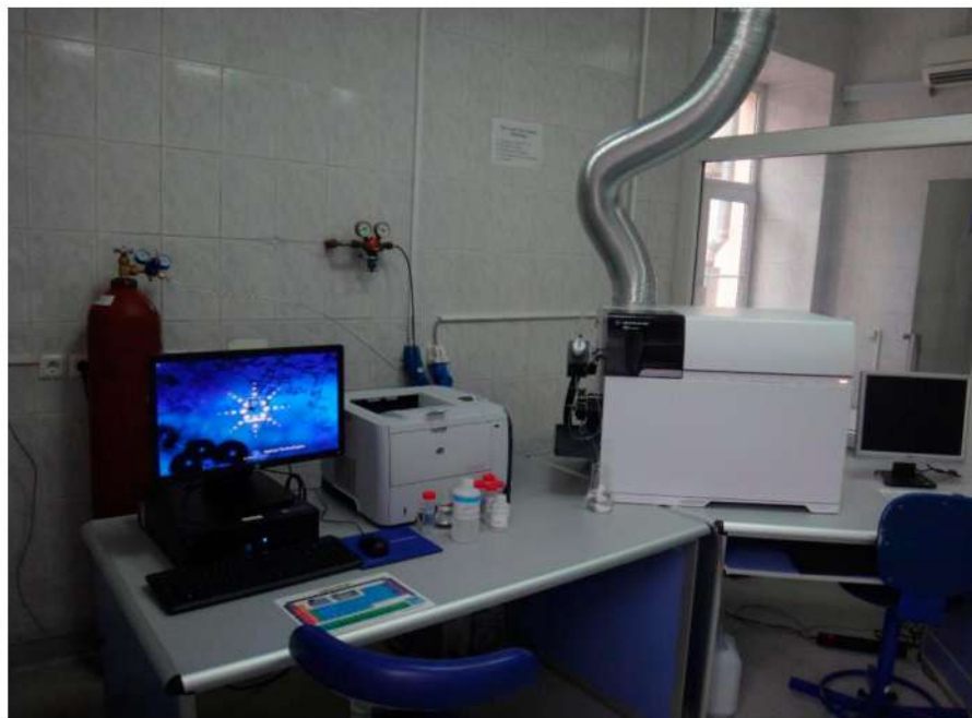
Рис. 14. Рабочая зона для микроэлементного анализа готовых биопроб с помощью масс-спектрометра с индуктивно связанной плазмой Agilent Technologies 7900.
