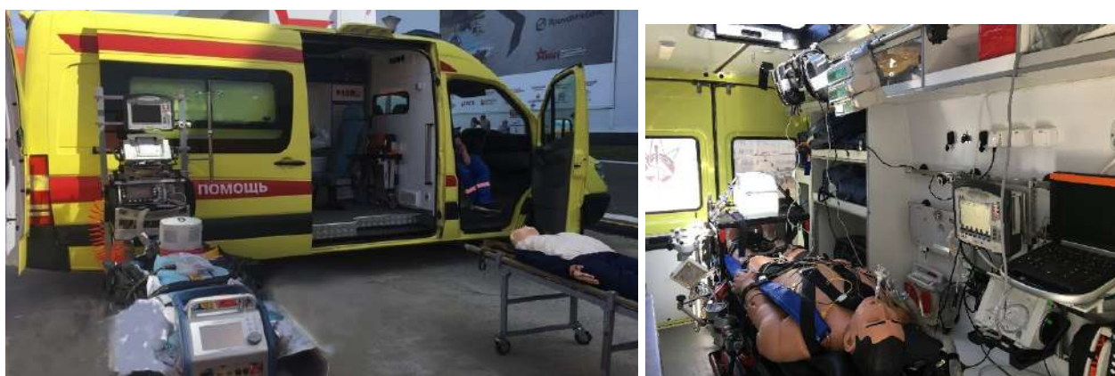
Рисунок 42. Машина класса С оборудованная транспортной ЭКМО, ФГБУ ВЦЭРМ им. А.М. Никитина МЧС России, 2014 г.
